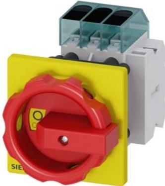
sezionatore sottocarico 3LD3, lu 25 A interruttore principale a 3 poli potenza di impiego nominale per AC-23 A con 400 V 9,0 kW fissaggio frontale interruttore base con fissaggio su foro centrale 22,5 mm comando a leva rosso/giallo 66x66 mm con blocchetto di contatti ausiliari 1NC+1NO
