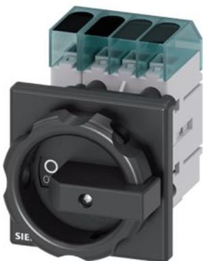
sezionatore sottocarico 3LD3, Iu 25 A interruttore principale a 3 poli + N potenza di impiego nominale per AC-23 A con 400 V 9,0 kW fissaggio frontale interruttore base con fissaggio su foro centrale 22,5 mm comando a leva nero 66x66 mm
