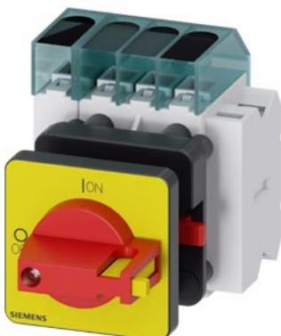
sezionatore sottocarico 3LD3, Iu 25 A interruttore principale a 3 poli + N potenza di impiego nominale per AC-23 A con 400 V 9,0 kW fissaggio frontale interruttore base con fissaggio su foro centrale 22,5 mm comando a leva rosso/giallo 48x48 mm con blocchetto di contatti ausiliari 1NC+1NO
