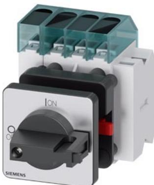
sezionatore sottocarico 3LD3, Iu 25 A interruttore principale a 3 poli + N potenza di impiego nominale per AC-23 A con 400 V 9,0 kW fissaggio frontale interruttore base con fissaggio su foro centrale 22,5 mm comando a leva nero 48x48 mm con blocchetto di contatti ausiliari 1NC+1NO
