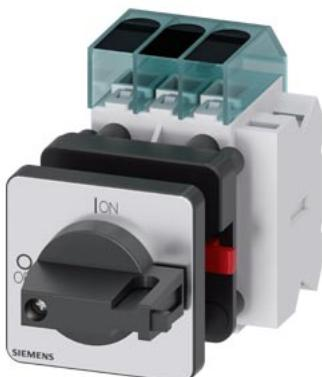
sezionatore sottocarico 3LD3, Iu 25 A interruttore principale a 3 poli potenza di impiego nominale per AC-23 A con 400 V 9,0 kW fissaggio frontale interruttore base con fissaggio su foro centrale 22,5 mm comando a leva nero 48x48 mm con blocchetto di contatti ausiliari 1NC+1NO
