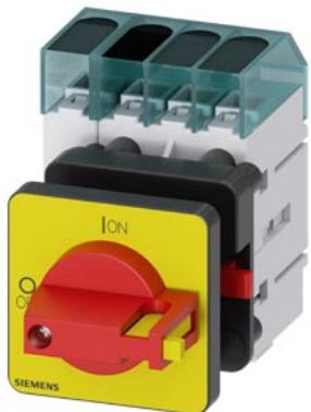
sezionatore sottocarico 3LD3, Iu 25 A interruttore principale a 3 poli + N potenza di impiego nominale per AC-23 A con 400 V 9,0 kW fissaggio frontale interruttore base con fissaggio su foro centrale 22,5 mm comando a leva rosso/giallo 48x48 mm
