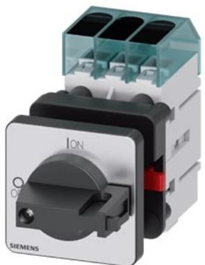
sezionatore sottocarico 3LD3, Iu 25 A interruttore principale a 3 poli potenza di impiego nominale per AC-23 A con 400 V 9,0 kW fissaggio frontale interruttore base con fissaggio su foro centrale 22,5 mm comando a leva nero 48x48 mm
