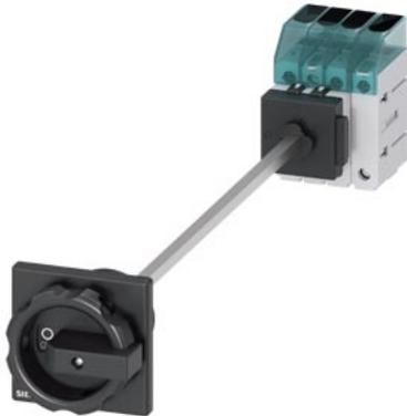
sezionatore sottocarico 3LD3, Iu 25 A interruttore principale a 3 poli + N potenza di impiego nominale per AC-23 A con 400 V 9,0 kW fissaggio sulla base di fondo interruttore base con bloccoporta fissaggio su foro centrale 22,5 mm comando rotativo nero 66 x 66 mm
