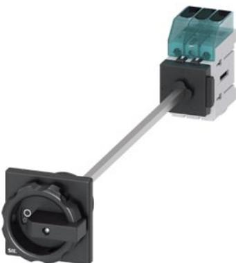
sezionatore sottocarico 3LD3, Iu 25 A interruttore principale a 3 poli potenza di impiego nominale per AC-23 A con 400 V 9,0 kW fissaggio sulla base di fondo interruttore base con bloccoporta fissaggio su foro centrale 22,5 mm comando rotativo nero 66 x 66 mm
