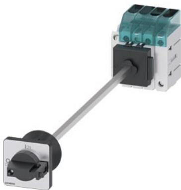
sezionatore sottocarico 3LD3, Iu 25 A interruttore principale a 3 poli + N potenza di impiego nominale per AC-23 A con 400 V 9,0 kW fissaggio sulla base di fondo interruttore base con bloccoporta fissaggio su foro centrale 22,5 mm comando a leva nero 48x48 mm con blocchetto di contatti ausiliari 1NC+1NO
