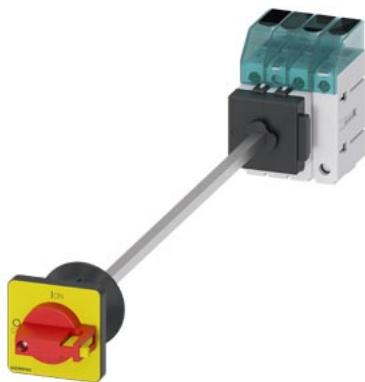
sezionatore sottocarico 3LD3, Iu 25 A interruttore principale a 3 poli + N potenza di impiego nominale per AC-23 A con 400 V 9,0 kW fissaggio sulla base di fondo interruttore base con bloccoporta fissaggio su foro centrale 22,5 mm comando a leva rosso/giallo 48x48 mm
