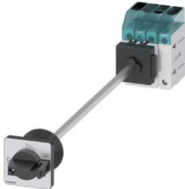
sezionatore sottocarico 3LD3, Iu 25 A interruttore principale a 3 poli + N potenza di impiego nominale per AC-23 A con 400 V 9,0 kW fissaggio sulla base di fondo interruttore base con bloccoporta fissaggio su foro centrale 22,5 mm comando a leva nero 48x48 mm
