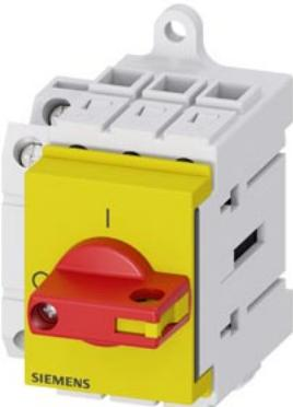
sezionatore sottocarico 3LD3, Iu 25 A interruttore principale a 3 poli potenza di impiego nominale per AC-23 A con 400 V 9,0 kW montaggio nel quadro di distribuzione interruttore base con Comando a leva rosso/giallo con blocchetto di contatti ausiliari 1NC+1NO
