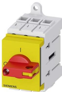
sezionatore sottocarico 3LD3, Iu 25 A interruttore principale a 3 poli potenza di impiego nominale per AC-23 A con 400 V 9,0 kW montaggio nel quadro di distribuzione interruttore base con Comando a leva rosso/giallo
