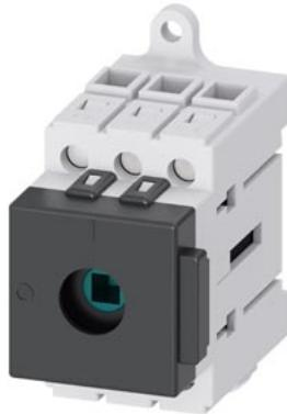
sezionatore sottocarico 3LD3, Iu 25 A interruttore principale a 3 poli potenza di impiego nominale per AC-23 A con 400V 9,0kW interruttore base senza comando a leva
