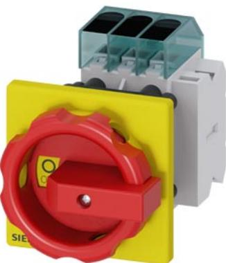
sezionatore sottocarico 3LD3, Iu 16 A interruttore principale a 3 poli potenza di impiego nominale per AC-23 A con 400 V 7,5 kW fissaggio frontale interruttore base con fissaggio su foro centrale 22,5 mm comando rotativo rosso/giallo 66 x 66 mm con blocchetto di contatti ausiliari 1NC+1NO
