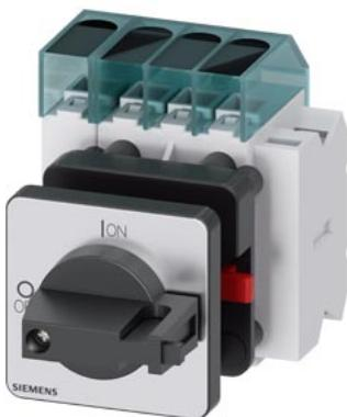
sezionatore sottocarico 3LD3, Iu 16 A interruttore principale a 3 poli + N potenza di impiego nominale per AC-23 A con 400 V 7,5 kW fissaggio frontale interruttore base con fissaggio su foro centrale 22,5 mm comando a leva nero 48x48 mm con blocchetto di contatti ausiliari 1NC+1NO
