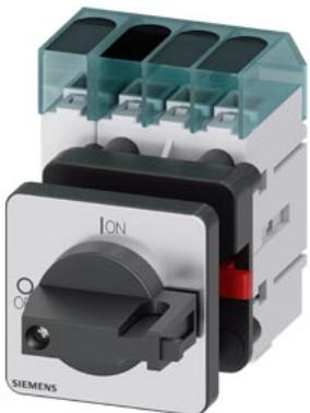
sezionatore sottocarico 3LD3, Iu 16 A interruttore principale a 3 poli + N potenza di impiego nominale per AC-23 A con 400 V 7,5 kW fissaggio frontale interruttore base con fissaggio su foro centrale 22,5 mm comando a leva nero 48x48 mm
