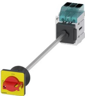
sezionatore sottocarico 3LD3, Iu 16 A interruttore principale a 3 poli potenza di impiego nominale per AC-23 A con 400 V 7,5 kW fissaggio sulla base di fondo interruttore base con bloccoporta fissaggio su foro centrale 22,5 mm comando a leva rosso/giallo 48x48 mm con blocchetto di contatti ausiliari 1NC+1NO
