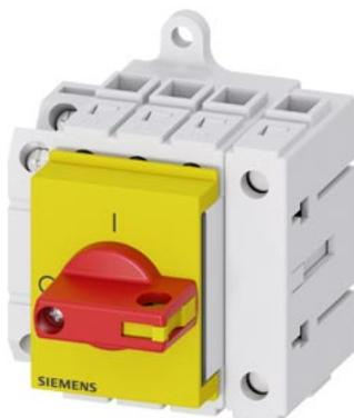
sezionatore sottocarico 3LD3, lu 16 A interruttore principale a 3 poli + N potenza di impiego nominale per AC-23 A con 400 V 7,5 kW montaggio nel quadro di distribuzione interruttore base con Comando a leva rosso/giallo con blocchetto di contatti ausiliari 1NC+1NO
