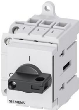
sezionatore sottocarico 3LD3, Iu 16 A interruttore principale a 3 poli potenza di impiego nominale per AC-23 A con 400 V 7,5 kW montaggio nel quadro di distribuzione interruttore base con comando a leva nero con blocchetto di contatti ausiliari 1NC+1NO
