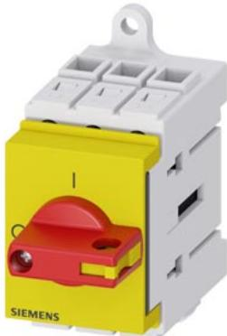
sezionatore sottocarico 3LD3, Iu 16 A interruttore principale a 3 poli potenza di impiego nominale per AC-23 A con 400 V 7,5 kW montaggio nel quadro di distribuzione interruttore base con Comando a leva rosso/giallo
