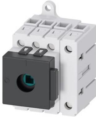
sezionatore sottocarico 3LD3, Iu 16 A interruttore principale a 3 poli + N potenza di impiego nominale per AC-23A con 400V 7,5kW interruttore base senza comando a leva
