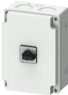
sezionatore sottocarico SENTRON 3LD nella custodia, interruttori per manutenzione e riparazione con lamierino di schermatura EMC, a 3 poli, Iu: 125A, AC 23 A 400 V a 50/60 Hz: 45 kW per funzionamento con convertitore: AC20 400V da 0 a 550 Hz: 45 kW, 1NO + 1NC anticipato di 20 ... 150ms, custodia in materiale isolante per raccordo a vite metrico, comando a leva, nero, bloccabile in posizione 0 e I, incl. mollette per lo schermo e fascette per tubi
