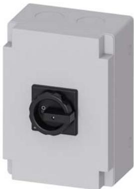
SENTRON, sezionatore sottocarico 3LD, interruttore principale, a 3 poli, Iu: 125 A, potenza in esercizio / per AC-23 A / con 400 V: 45 kW, custodia in materiale isolante per raccordo a vite metrico, comando rotativo, nero
