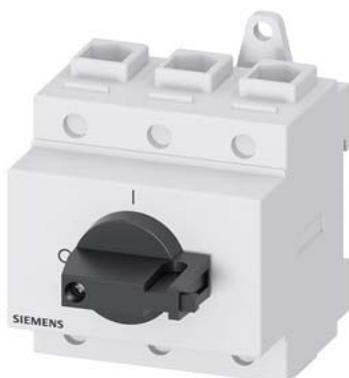
SETRON, sezionatore sottocarico 3LD, interruttore principale, a 3 poli, lu: 125 A, potenza in esercizio / per AC-23 A / con 400 V: 45 kW, montaggio nel quadro di distribuzione, comando a leva, nero, operatore direttamente sull'interruttore
