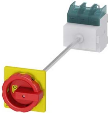
SETRON, sezionatore sottocarico 3LD, interruttore di arresto di emergenza, 3-poli, Iu: 125 A, potenza di impiego / per AC-23 A con 400 V: 45 kW, fissaggio su base con bloccoporta, comando rotativo, rosso/giallo fissaggio a 4 fori dell'operatore
