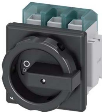
SENTRON, sezionatore sottocarico 3LD, interruttore principale, a 3 poli, Iu: 125 A, potenza in esercizio / per AC-23 A / con 400 V: 45 kW, fissato frontalmente, 1 NC, 1 NO, comando rotativo, nero, 4 fori dell'operatore
