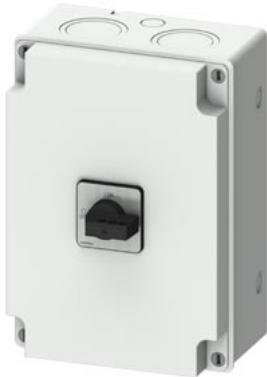
sezionatore sottocarico SENTRON 3LD nella custodia, interruttori per manutenzione e riparazione con lamierino di schermatura EMC, a 3 poli, Iu: 100A, AC 23 A 400 V a 50/60 Hz: 37 kW per funzionamento con convertitore: AC20 400V da 0 a 550 Hz: 37 kW, 1NO + 1NC anticipato di 20 ... 150ms, custodia in materiale isolante per raccordo a vite metrico, comando a leva, nero, bloccabile in posizione 0 e I, incl. mollette per lo schermo e fascette per tubi
