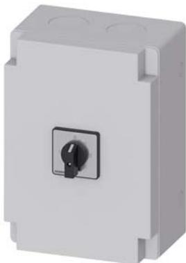
SENTRON, sezionatore sottocarico 3LD, commutatore, a 3 poli, lu: 100 A, potenza di impiego / a AC-23 A con 400V: 37 kW, custodia in materiale isolante per raccordo a vite metrico, comando a leva, nero
