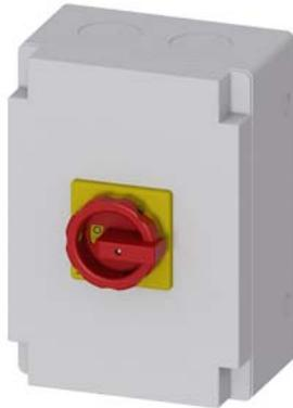
SETRON, sezionatore sottocarico 3LD, interruttore di arresto di emergenza, 3-poli, Iu: 100 A, potenza di impiego / per AC-23 A con 400 V: 37 kW, custodia in materiale isolante per pressacavo metrico, 1 NC, 1 NO, comando rotativo, rosso/giallo
