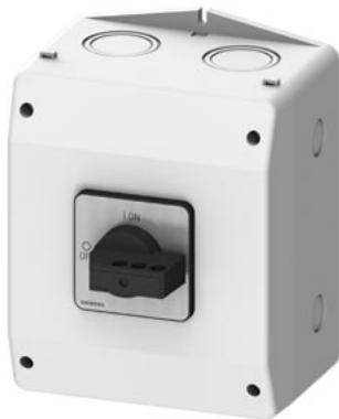
sezionatore sottocarico SENTRON 3LD nella custodia, interruttori per manutenzione e riparazione con lamierino di schermatura EMC, a 3 poli, Iu: 63A, AC 23 A 400 V a 50/60 Hz: 22 kW per funzionamento con convertitore: AC20 400V da 0 a 550 Hz: 18,5 kW, 1NO + 1NC anticipato di 20 ... 150ms, custodia in materiale isolante per raccordo a vite metrico, comando a leva, nero, bloccabile in posizione 0 e I, incl. mollette per lo schermo e fascette per tubi
