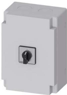
SENTRON, sezionatore sottocarico 3LD, commutatore, a 3 poli, Iu: 63 A, potenza di impiego / a AC-23 A con 400V: 22 kW, custodia in materiale isolante per raccordo a vite metrico, comando a leva, nero
