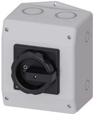
SENTRON, sezionatore sottocarico 3LD, interruttore principale, a 4 poli, 63 A, potenza di impiego con AC 23 A con 400 V: 22 kW, custodia in materiale isolante per raccordo a vite metrico, comando rotativo, nero
