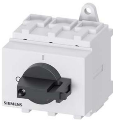
SENTRON, sezionatore sottocarico 3LD, interruttore principale, a 3 poli, I<sub>u</sub>: 63 A, potenza in esercizio / per AC-23 A / con 400 V: 22 kW, montaggio nel quadro di distribuzione, comando a leva, nero, operatore direttamente sull'interruttore
