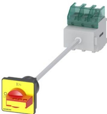
SENTRON, sezionatore sottocarico 3LD, interruttore di arresto di emergenza, a 3 poli, Iu: 63 A, potenza in esercizio / per AC-23 A / con 400 V: 22 kW, fissaggio su base con bloccoporta, comando a leva comando a leva, rosso/giallo fissaggio a 4 fori dell'operatore
