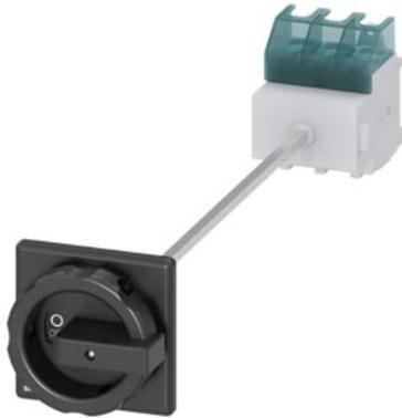
SETRON, sezionatore sottocarico 3LD, interruttore principale, a 3 poli, Iu: 63 A, potenza in esercizio / per AC-23 A / con 400 V: 22 kW, fissaggio su base con bloccoporta, comando rotativo, nero, fissaggio a 4 fori dell'operatore
