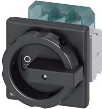
SETRON, sezionatore sottocarico 3LD, interruttore principale, a 3 poli, Iu: 63 A, potenza in esercizio / per AC-23 A / con 400 V: 22 kW, fissato frontalmente, 1 NC, 1 NO, comando rotativo, nero, 4 fori dell'operatore
