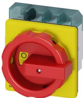
SETRON, sezionatore sottocarico 3LD, interruttore di arresto di emergenza, 4-poli, Iu: 63 A, potenza di impiego / per AC-23 A con 400 V: 22 kW, fissato frontalmente, comando rotativo, rosso/giallo fissaggio a 4 fori dell'operatore
