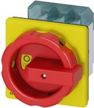
SETRON, sezionatore sottocarico 3LD, interruttore di arresto di emergenza, 3-poli, Iu: 63 A, potenza di impiego / per AC-23 A con 400 V: 22 kW, fissato frontalmente, comando rotativo, rosso/giallo fissaggio a 4 fori dell'operatore
