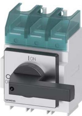
SENTRON, sezionatore sottocarico 3LD, interruttore principale, a 3 poli, I<sub>u</sub>=250A, potenza in esercizio / per AC-23 A / con 400 V: 132 kW, montaggio nel quadro di distribuzione, comando a leva, nero, operatore direttamente sull'interruttore
