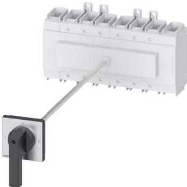
SENTRON, sezionatore sottocarico 3LD, commutatore, a 4 poli,  $I_{u} = 250 \text{ A}$ , potenza di impiego / a AC-23 A con 400V: 132 kW, fissaggio su base con bloccoporta, comando a leva, nero, fissaggio a 4 fori dell'operatore
