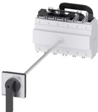
SENTRON, sezionatore sottocarico 3LD, commutatore, a 3 poli, I<sub>u</sub>= 250 A, potenza di impiego / a AC-23 A con 400V: 132 kW, fissaggio su base con bloccoporta, comando a leva, nero, fissaggio a 4 fori dell'operatore
