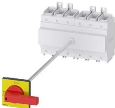
SENTRON, sezionatore sottocarico 3LD, interruttore di arresto di emergenza, 6-pol,  $I_{u}=250A$ , potenza di impiego / per AC-23 A con 400 V: 132 kW, fissaggio su base con bloccoporta, comando a leva, rosso/giallo fissaggio a 4 fori dell'operatore
