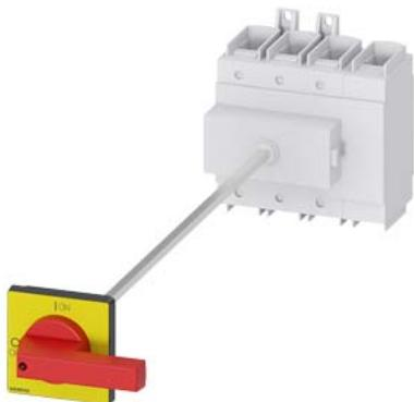
SENTRON, sezionatore sottocarico 3LD, interruttore di arresto di emergenza, 4-polosi,  $I_{u}=250\text{A}$ , potenza di impiego / per AC-23 A con 400 V: 132 kW, fissaggio su base con bloccoporta, comando a leva, rosso/giallo fissaggio a 4 fori dell'operatore
