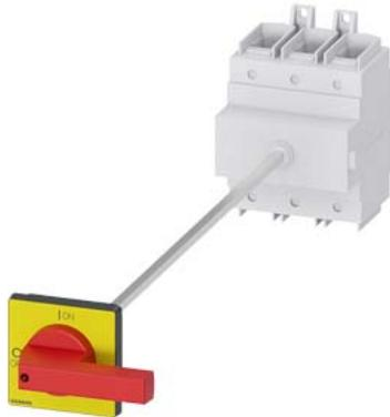
SETRON, sezionatore sottocarico 3LD, interruttore di arresto di emergenza, 3-poli, I<sub>n</sub>=250A, potenza di impiego / per AC-23 A con 400 V: 132 kW, fissaggio su base con bloccoporta, comando a leva, rosso/giallo fissaggio a 4 fori dell'operatore
