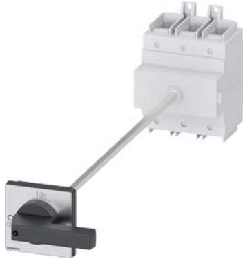
SETRON, sezionatore sottocarico 3LD, interruttore principale, a 3 poli,  $I_n=250A$ , potenza in esercizio / per AC-23 A / con 400 V: 132 kW, fissaggio su base con bloccoporta, comando a leva, nero, fissaggio a 4 fori dell'operatore
