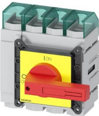
SENTRON, sezionatore sottocarico 3LD, interruttore di arresto di emergenza, 4-pol, Iu=250A, potenza di impiego / per AC-23 A con 400 V: 132 kW, fissato frontalmente, comando a leva, rosso/giallo fissaggio a 4 fori dell'operatore
