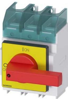
SENTRON, sezionatore sottocarico 3LD, interruttore di arresto di emergenza, 3-pol., I<sub>u</sub>: 160 A, potenza di impiego / per AC-23 A con 400 V: 75 kW, montaggio nel quadro di distribuzione, comando a leva, rosso/giallo operatore direttamente sull'interruttore
