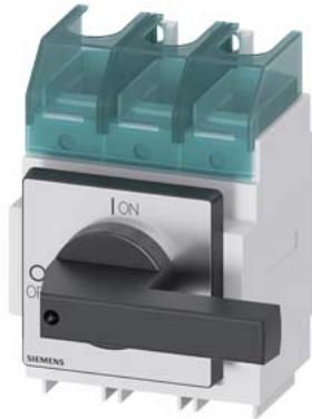
SETRON, sezionatore sottocarico 3LD, interruttore principale, a 3 poli, Iu: 160 A, potenza in esercizio / per AC-23 A / con 400 V: 75 kW, montaggio nel quadro di distribuzione, comando a leva, nero, operatore direttamente sull'interruttore
